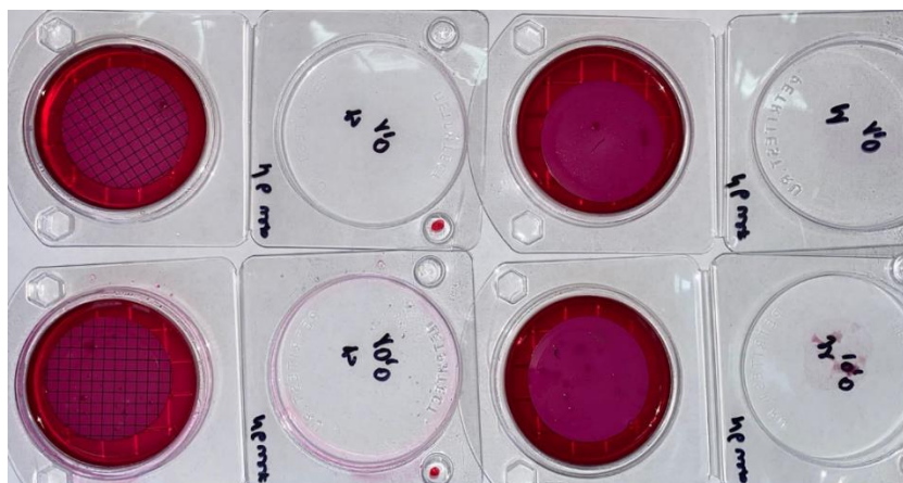
Рисунок 4. Результаты посевов проб образцов поверхностной воды и сточной воды методом мембранной фильтрации
